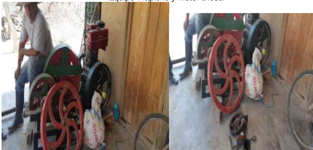
Equipo Trapiche y Motor Diesel Sin funcionar y Desarmado. Foto- Equipo Auditor.
